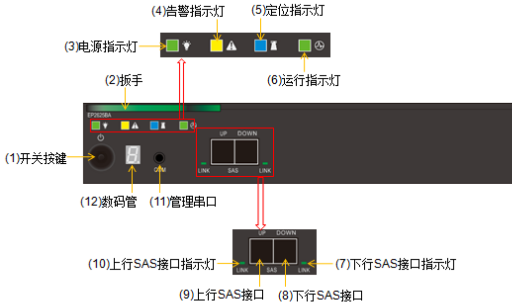
图3-12 DSU2625B 的 EP 正视图
