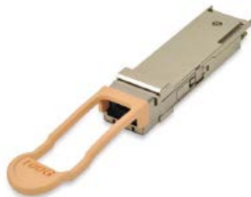
图4-41 100GE 光模块示意图
